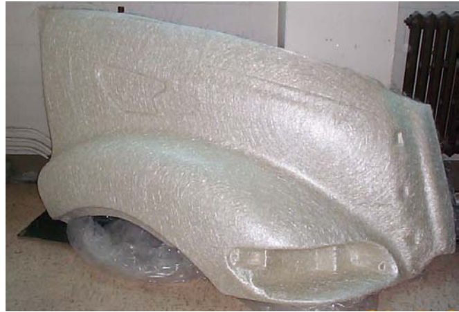
Préforme d'une aile avant de camion
