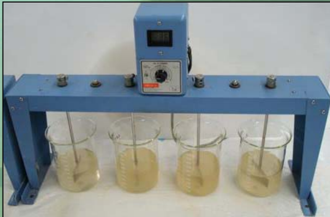
Banc d'essai HS-4 pour jars tests
